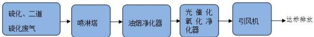
图4-5 硫化车间废气处理工艺流程图
